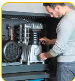
Dotados de un panel anterior practicable que facilita la accesibilidad y el mantenimiento de todos los componentes internos. El nivel de aceite es fácilmente visible y el rellenado resulta muy simple, gracias a la favorable posición del grupo cabezal
